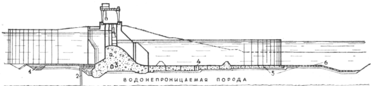
Схема водосливной плотины Горьковской ГЭС (в разрезе). 1. Водонепроницаемое покрытие дна. 2. Противофильтрационная железобетонная стенка. 3. Подземный «коридор» для размещения наблюдательных приборов. 4—5—6. Покрытие против размыва дна.
